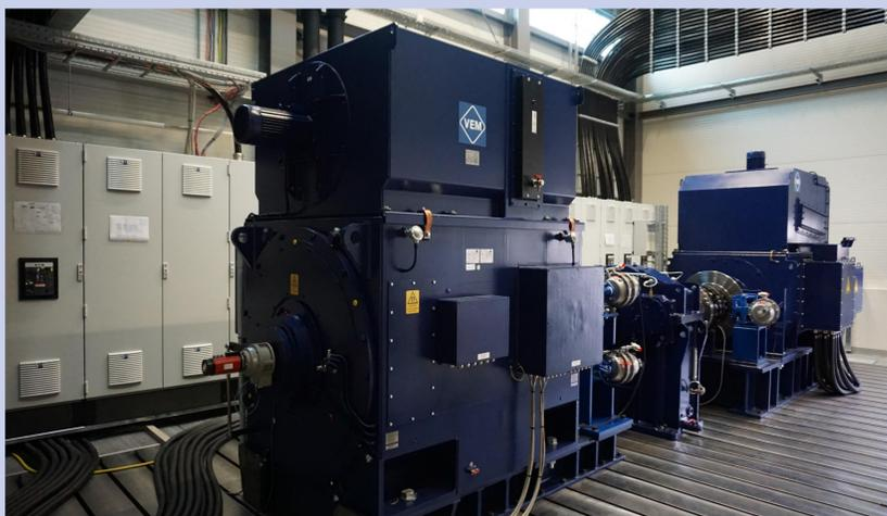
Abb. 4. Generator-Umrichter-Prüfstand Untersuchung elektrischer Energiewandler in Antriebssträngen von WEA
