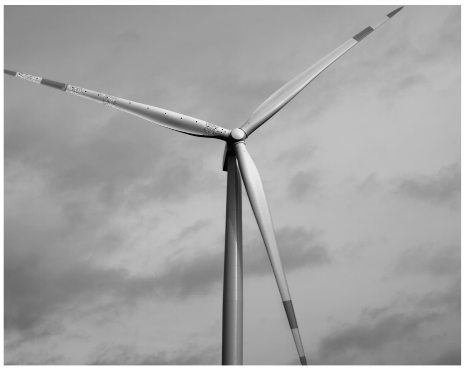
Links: Prüfstand bei Experimenten mit direktem Sonnenlicht im Freien. Rechts: Windenergieanlage mit Punktemustern
